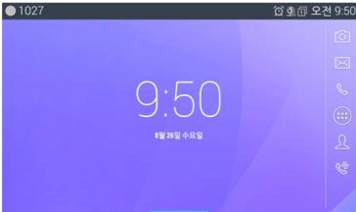
SIP 서버 네트워크 설정이 변경되거나 전화기가 원격으로 설치 되었을 경우 전화기 등록 진행이 안되며, 이 경우 등록 되지 않은 상태로 화면 좌측 상단에 회색 모양으로 나타납니다. 해결을 위해서는 시스템 관리 담당자의 도움을 받아 전화기 등록을 하시기 바랍니다. 그 외 IP 설정, 시스템 변경을 할 경우에도 시스템 관리 담당자의 도움을 받아 진행하시기 바랍니다.
